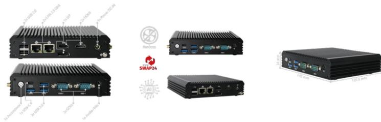
Il mini BOX PC GDT-7100N è un PC fanless compatto, ideale per applicazioni speciali che richiedono silenziosità, affidabilità e bassi consumi (solo 6W TDP). Dotato di processore Intel® N100 con grafica 4K UHD 600 e scheda audio integrata a 6 canali, offre elevate prestazioni simili a quelle di un Core i3.
