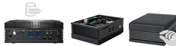
Il GDT-9510N offre prestazioni performance in un mini-case compatto e robusto. Basato su processori di dodicesima generazione Intel® Core™ i5 o i7, integra una grafica Intel® Iris® Xe Graphics. Equipaggiato con dischi allo stato solido (SSD) di nuova generazione che garantiscono livelli di affidabilità molto elevati, con un rapporto prezzo-prestazioni davvero interessante. Opzionalmente è inoltre possibile installare due SSD in modalità RAID1.
