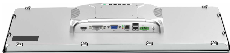
Versione con ricevitore KVM integrato (su richiesta)
