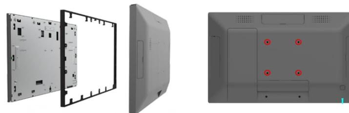
Progettato per ambienti industriali e alimentari, il Panel PC della Serie KP con processori Intel® N97 a basso consumo offre una struttura robusta e completamente sigillata. La scocca in alluminio con rivestimento ceramico garantisce eccellente dissipazione del calore, facilità di pulizia, resistenza a olio, acqua ed agenti corrosivi.
