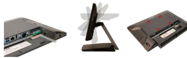
Soluzione fanless che sfrutta lo chassis in alluminio pressofuso per la dissipazione del calore e dotata di dischi SSD NVMe ad alta velocità per aumentare l'affidabilità e la silenziosità della soluzione.
