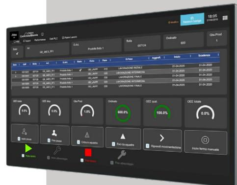
**Scocca in alluminio con rivestimento ceramico, display da 15,6" o 21,5" Full HD e sistema operativo Android 14.**
