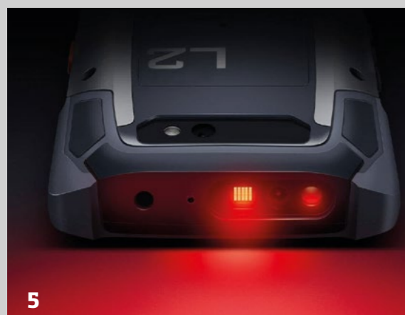
1. Rugged design dell'AT 1850 | 2. Ampia connettività WiFi+4G LTE del palmare M2 per la presa comande in mobilità | 3. Protezione IP 67 per il mobile computer L2S | 4. L' L2K è predisposto per la scansione di codici 1D/2D ed è utilizzabile con guanti da lavoro | 5 e 6. Potente scanner 1D/2D integrato nell'L2S.
