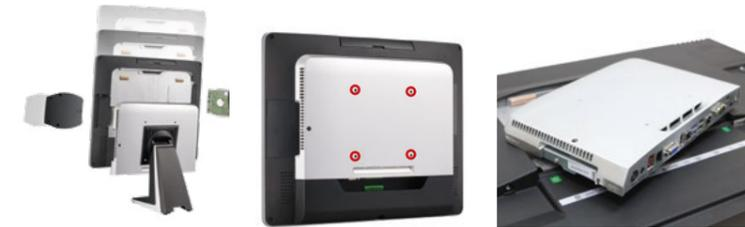
La sezione display è facilmente separabile dall'unità centrale sia per interventi di manutenzione che per sostituzione con display di maggiori dimensioni (22" o 32"). Pensato per ridurre l'ingombro, attraverso un attento studio di progettazione, offre una ricca sezione di I/O con connettività Wi-Fi opzionale integrata e una ricca scelta di periferiche di riconoscimento associabili (lettori MSR, RFID, scanner etc.).
