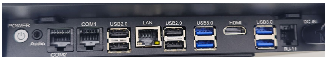
Porte I/O inferiori senza cavo di alimentazione collegato.
