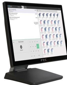
Lo chassis in alluminio pressofuso garantisce un'elevata stabilità del sistema, la solida base di sostegno permette un ampio angolo di inclinazione e garantisce stabilità al tocco.
