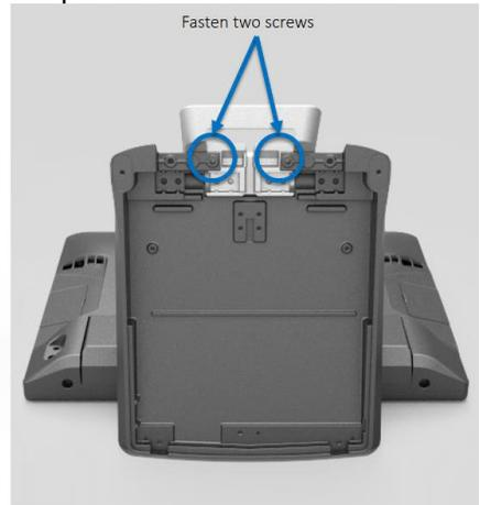
STEP 5: Posiziona la base come mostrato nell'immagine a sinistra e poi, con il cacciavite, avvita le due viti indicate sull'immagine a destra.
