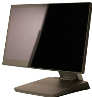
Basato sui processori Intel® Celeron di decima generazione, offre prestazioni elevate con consumi ridotti. Il sistema è equipaggiabile con dischi SSD fanless ad alta velocità, che eliminano le parti meccaniche in movimento e aumentano l'affidabilità complessiva della soluzione.
